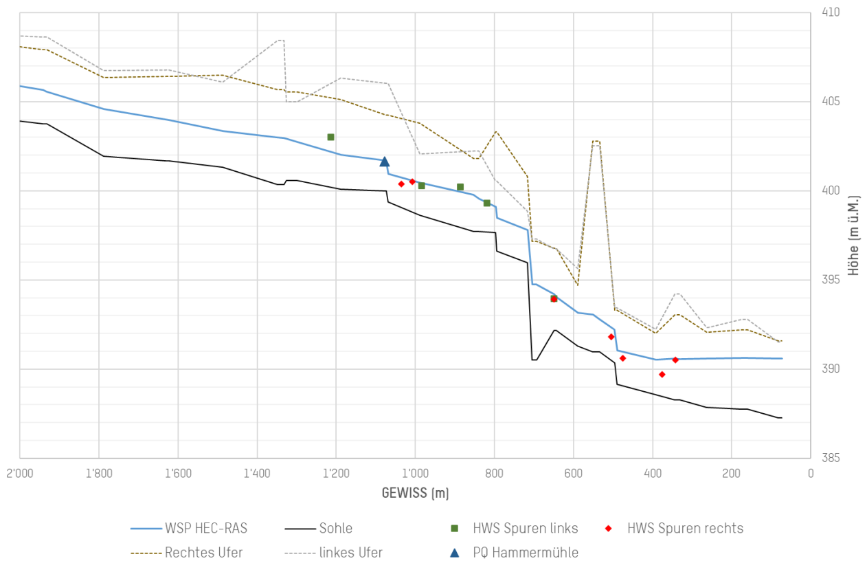
Abbildung 109: Vergleich der aufgenommenen Hochwasserspuren des Ereignisses vom 09.08.2007 mit den berechneten Wasserspiegellagen
