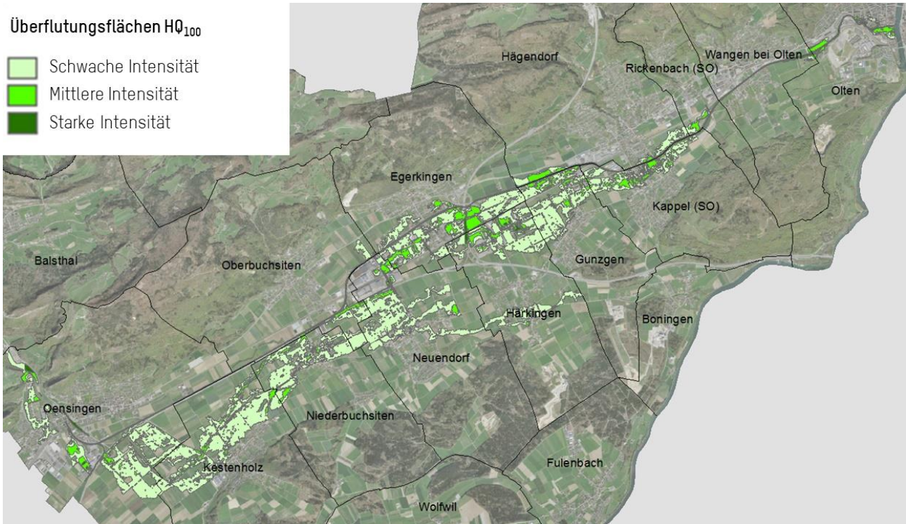
Abbildung 14: Intensitätskarte Hochwasser Dünern, Ist-Zustand HQ 100 mit «Bruttobetrachtung» [21].
