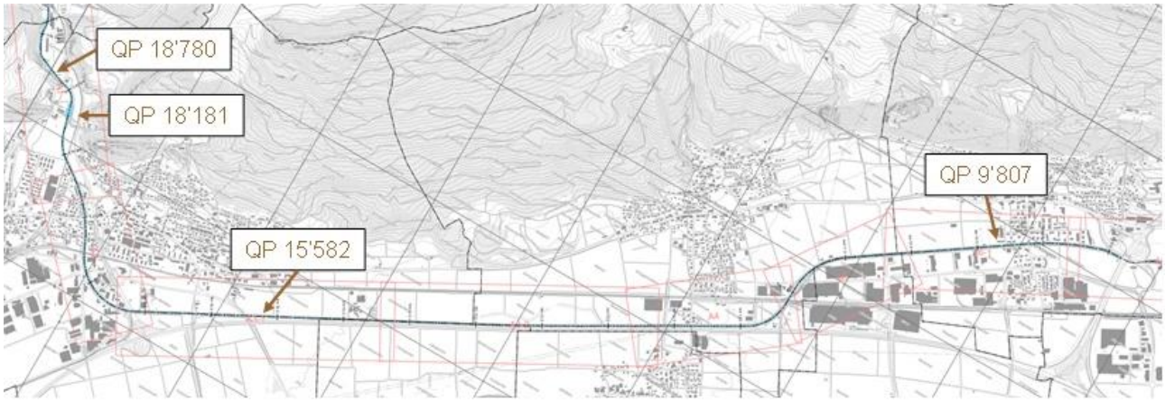
Abbildung 49: Übersicht der berücksichtigten Querprofile der Geschiebetransportkapazitätsberechnungen.
