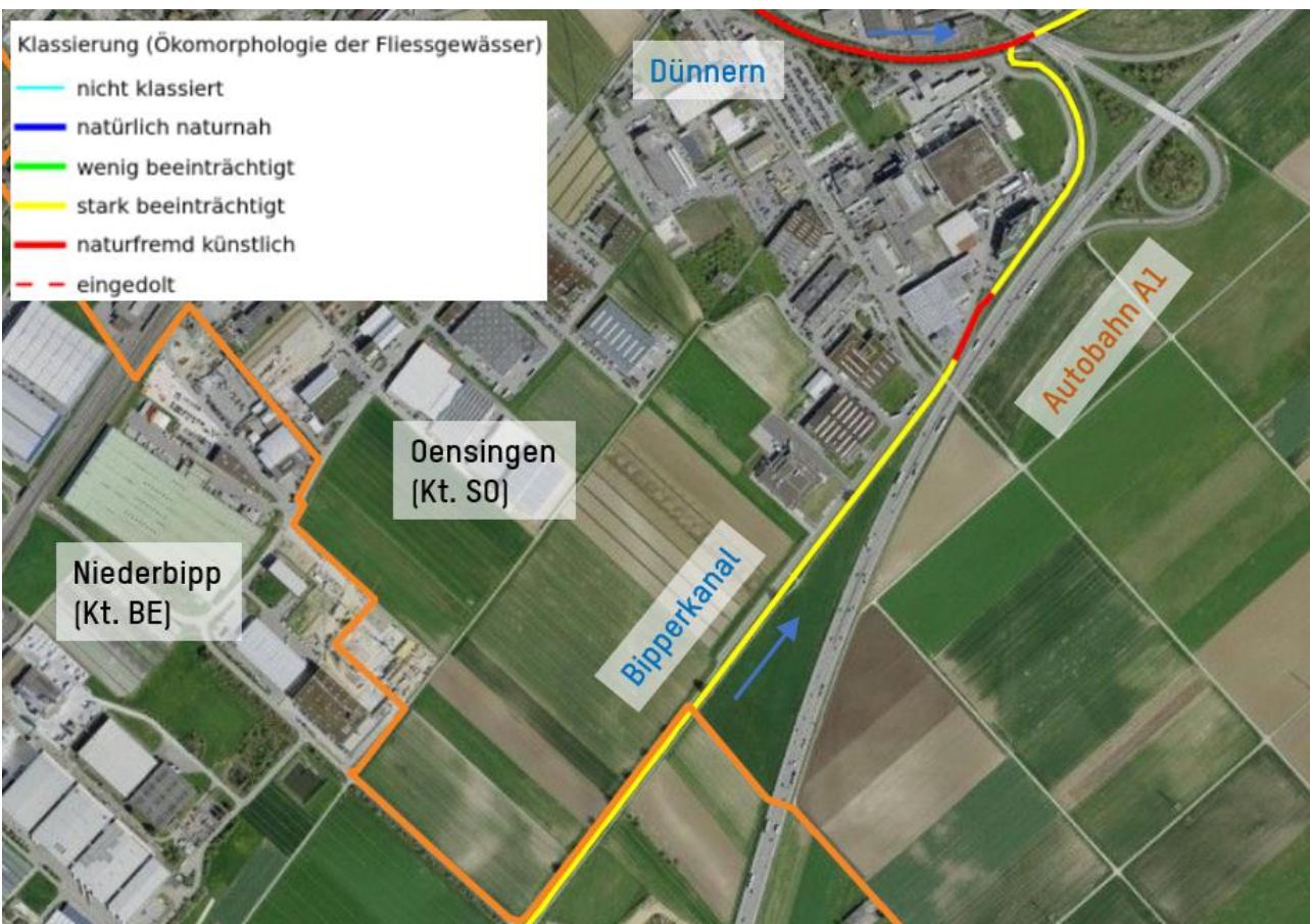
Abbildung 92: Ausschnitt ökomorphologischer Zustand des Bipperbachs im Kanton Solothurn [55]. In orange ist die Kantonsgrenze (Bern, Solothurn) dargestellt. Die blauen Pfeile zeigen die Fließrichtung des Bipperbachs, respektive der Dünern.
