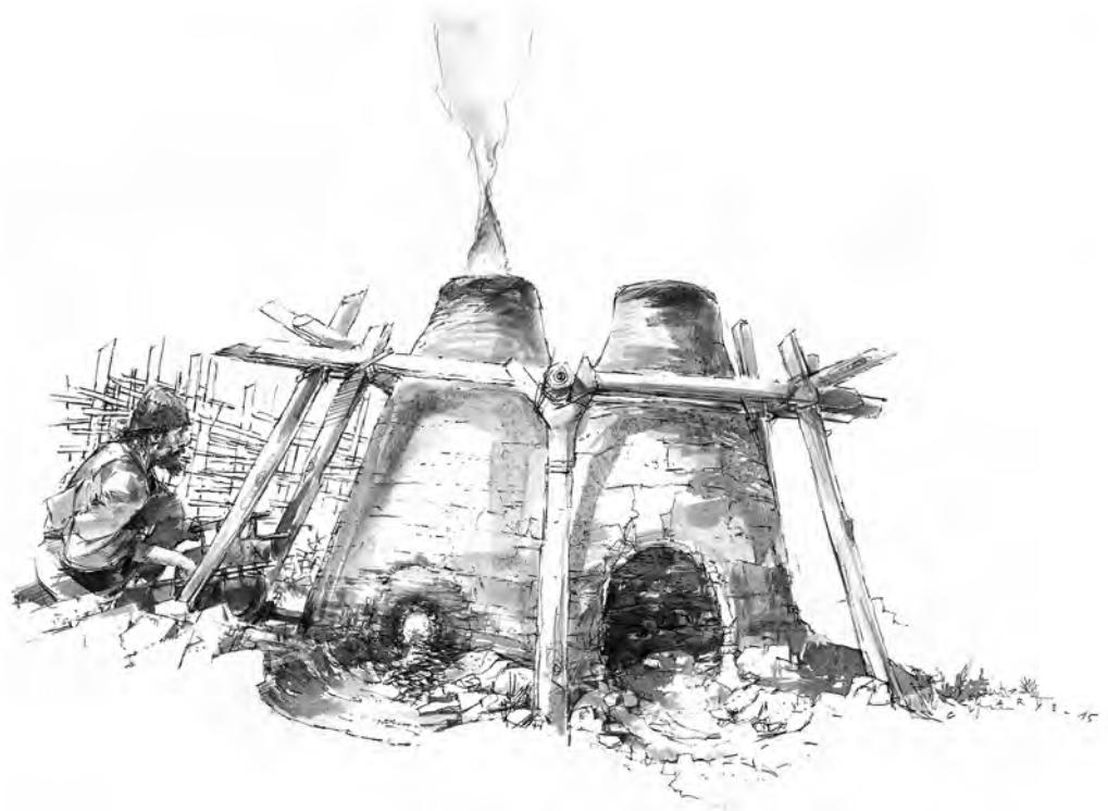
Abb. 6 Rekonstruktion zweier Rennöfen, in denen Eisenerz verhüttet wurde.
