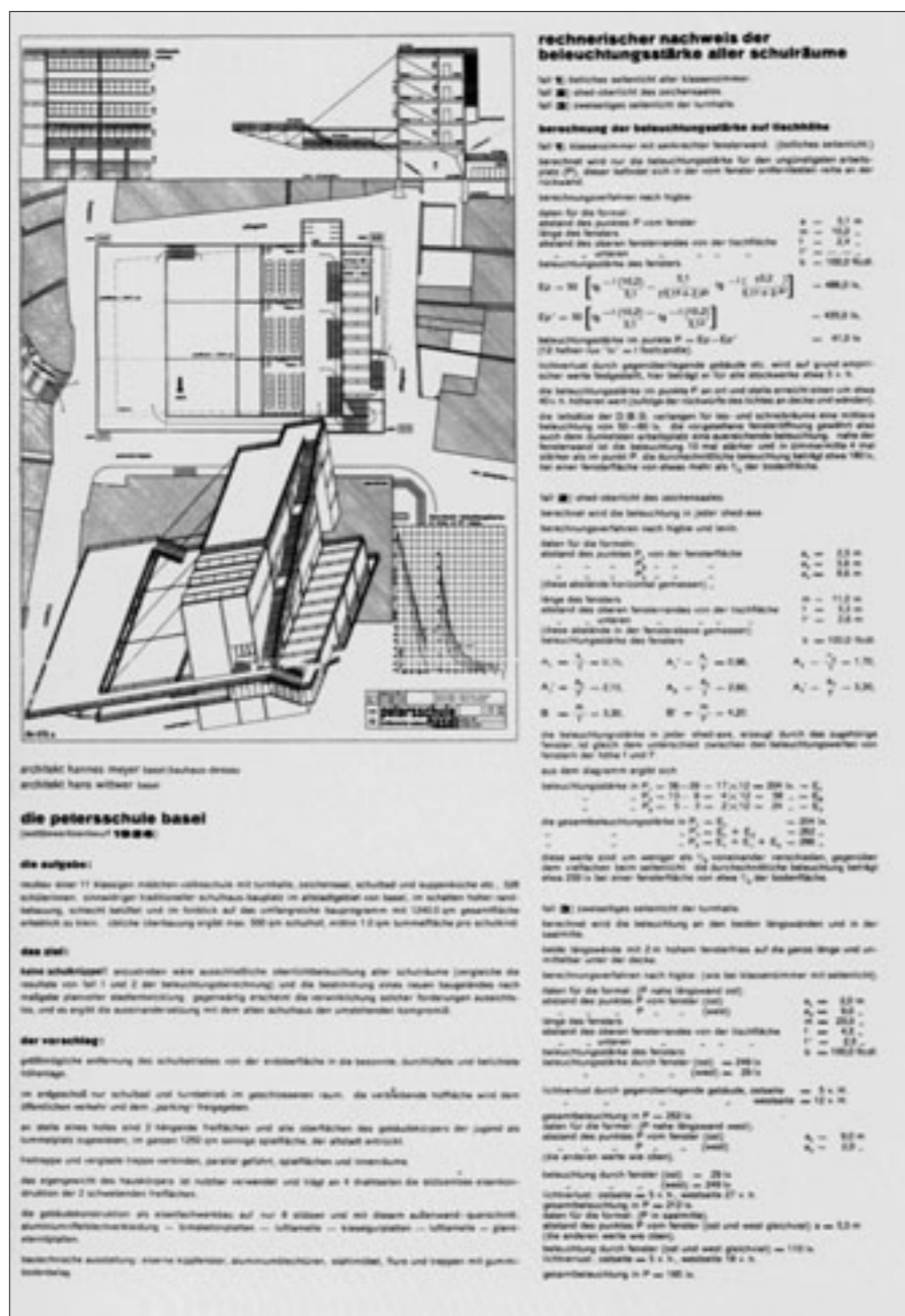
Abb. 10 Hannes Meyer und Hans Wittwer, Wettbewerbsentwurf Petersschule in Basel (1926), Erläuterung zum Schulhaus mit rechnerischem Nachweis der Beleuchtungsstärke (in: Wittwer 1989, Abb. 1).
