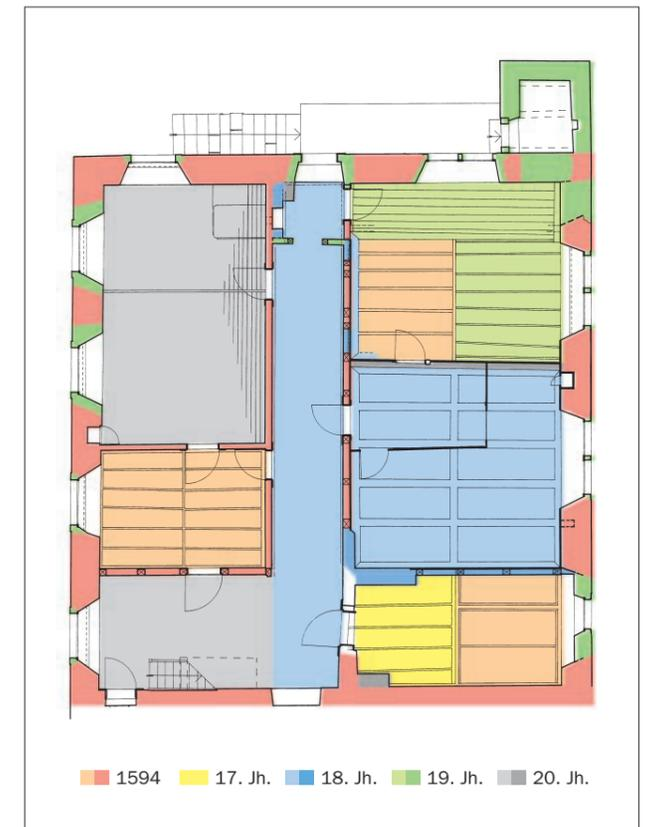
**Abb. 14** Grundriss 1. Obergeschoss, Zustand 1999 mit eingezeichneten Bauphasen. Die flächigen Färbungen in den Räumen betreffen die Holztäfer- und Gipsdecken.
