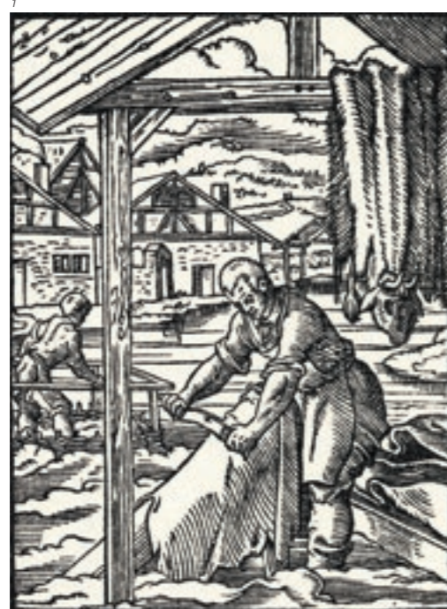
Abb. 1 Der «Lederer» aus dem Ständebuch des Jost Amman von 1568. Im Vordergrund schabt der Gerber auf dem Schabebaum mit dem Scherdegen Fleisch- und Fettreste beziehungsweise Haare von einer Haut. Links im Hintergrund steht ein Mitarbeiter in einer Lohgrube.
