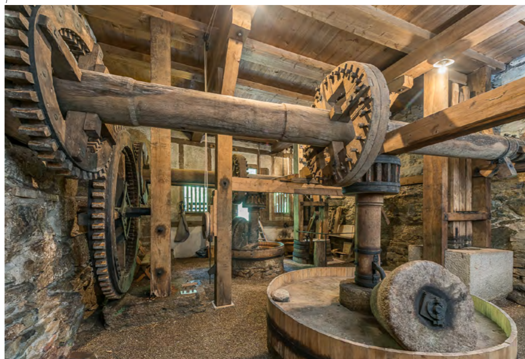
Abb. 1 Lütterswil-Gächliwil, Grabenöle, Grabenöliweg 1. Blick in den Ölraum in einer Aufnahme von 2017. Im Hintergrund in der Bildmitte der 2019/2020 restaurierte Wellbaum mit Korbrad.
