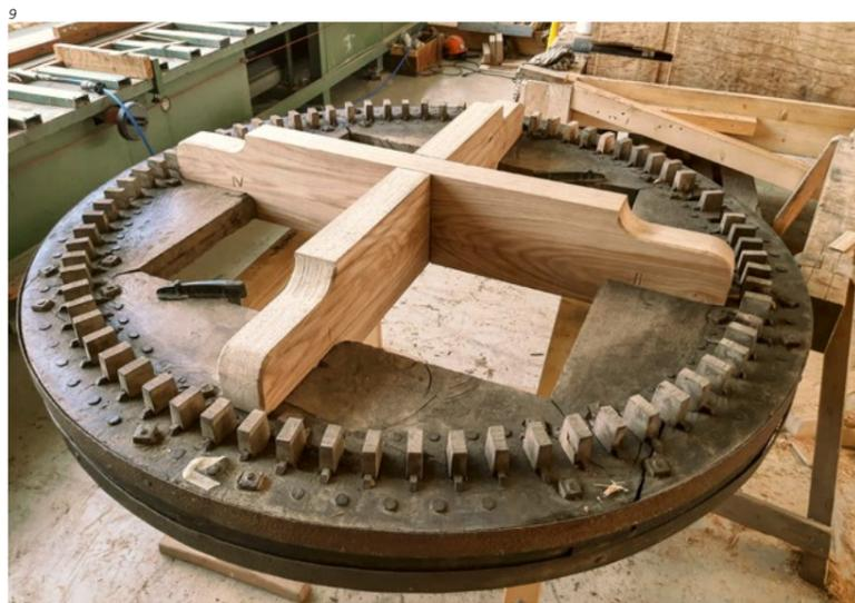
de bedeuten, dass das Kammrad in seinen Teilen – Grundscheiben, Felgen und Kämme – möglicherweise durchaus älter sein könnte. Holzanalysen wurden aber noch nicht durchgeführt. Die Kreuzarme, die 2022 vorgefunden wurden, stammten vermutlich von 1957/1958. Sie passten von der Machart und vom Duktus her nicht zu den restlichen Holzteilen des Kammrades (Abb. 9).
