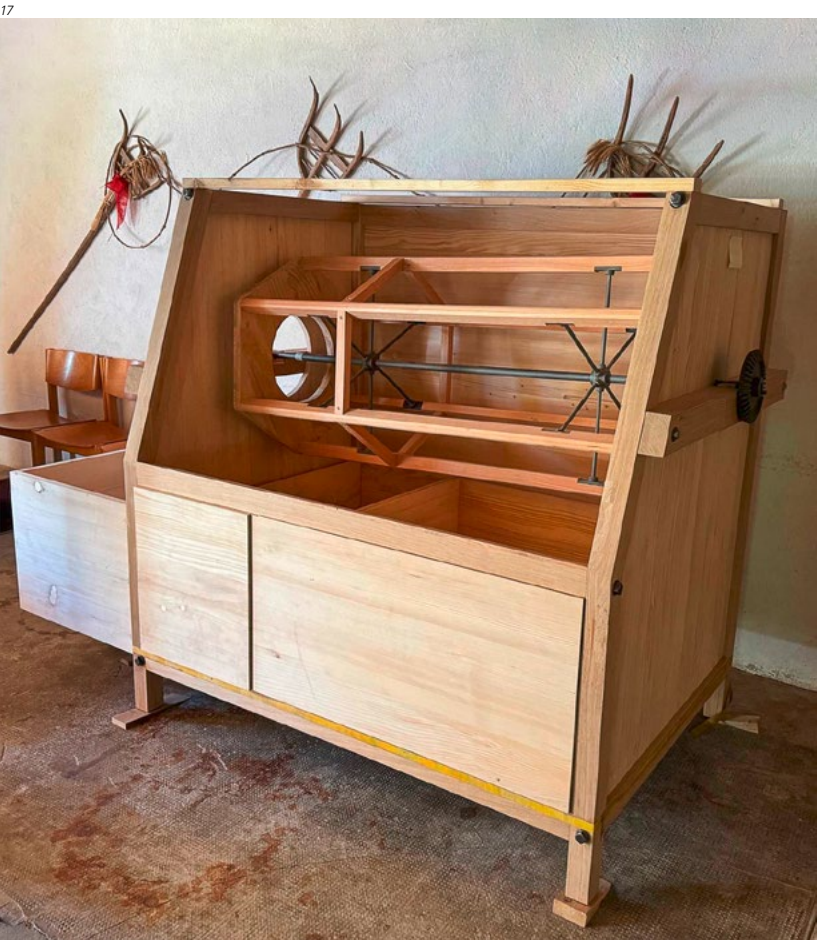
Abb. 18 Die Haspel wird in der Werk- statt mit Holmen versehen.
