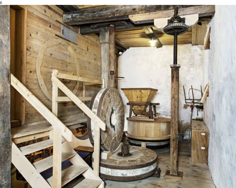
Abb. 5 Blick in den Mühlenraum mit dem Mahlboden und den Mahlgängen, dem darunterliegenden Getriebe mit seinen Kamm- und Zahnrädern, den Wellen sowie dem neu gebauten Sechskantsichter (links).
