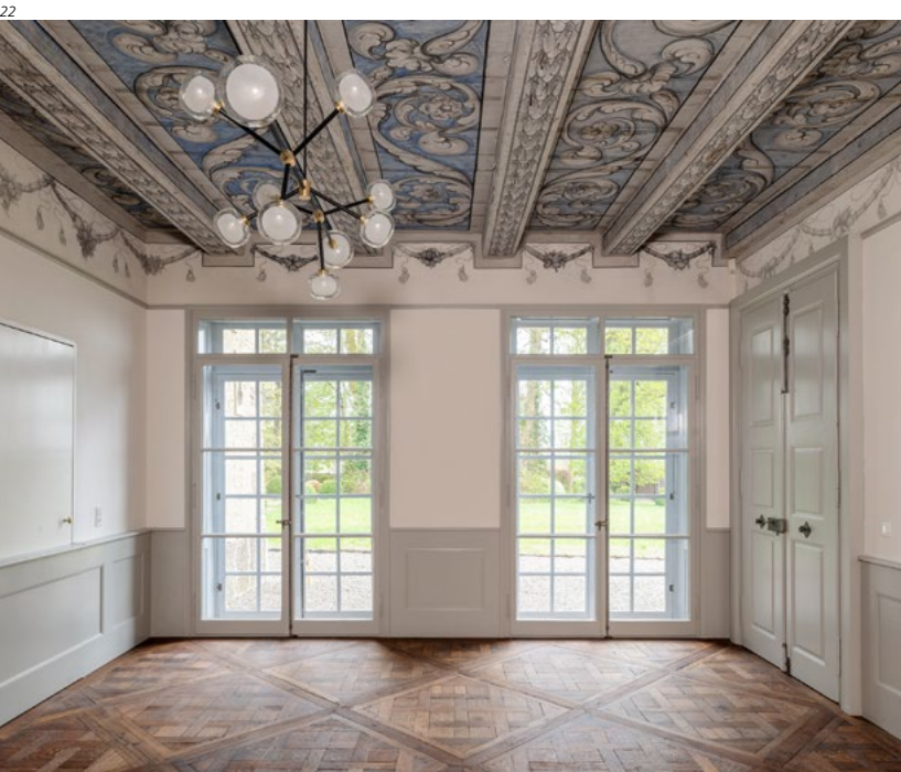
Abb. 22 Das Esszimmer im Erdgeschoss nach der Restaurierung. Die Rekonstruktionen und Ergänzungen wurden etwas heller und kontrastärmer ausgeführt und sind somit gut vom Original unterscheidbar.
