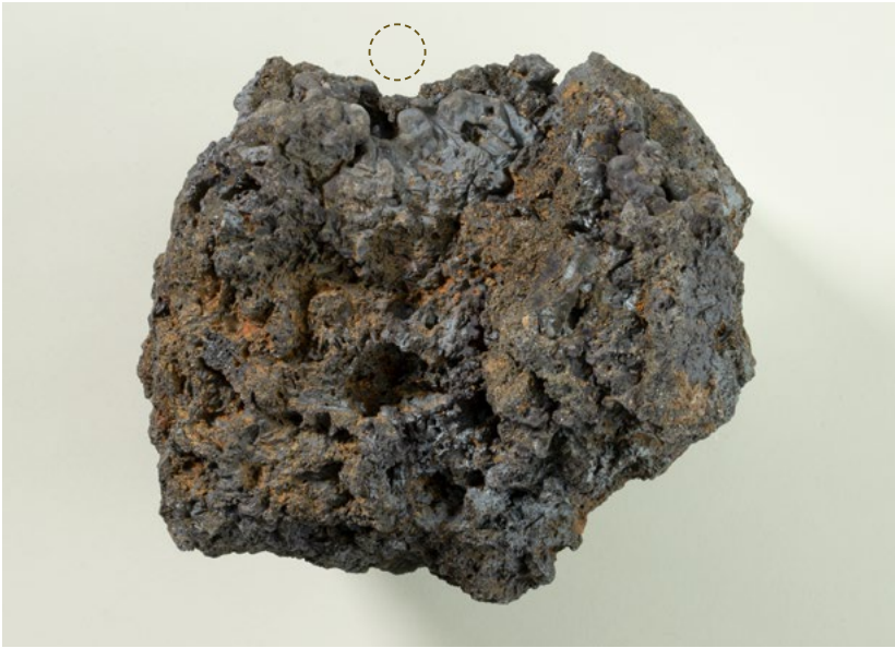
Abb. 25 An der oberen Kante dieser 5,4 Kilogramm schweren, grau-porösen Schlacke ist die ausgesparte Düsenmündung zu erkennen. Durch die Düse wurde Luft von den Blasebälgen in den Ofen geblasen. M 1:3.
