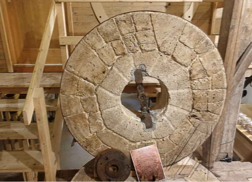
Abb. 10 Der zu Schauzwecken aufgestellte obere Mühlstein des zweiten Mahlgangs. Das Schärfen der Steine und das Spitzens von kleinen und grösseren Furchen und Flächen war eine eigene Kunst.
