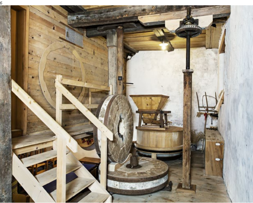
Abb. 5 Blick in den Mühlenraum mit dem Mahlboden und den Mahlgängen, dem darunterliegenden Getriebe mit seinen Kamm- und Zahnrädern, den Wellen sowie dem neu gebauten Sechskantsichter (links).
