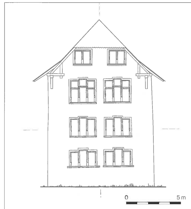
Abb. 17 Südfassade im Zustand, wie sie sich zwischen zirka 1650 und 1740 präsentierte. Rekonstruktion nach Befund.
