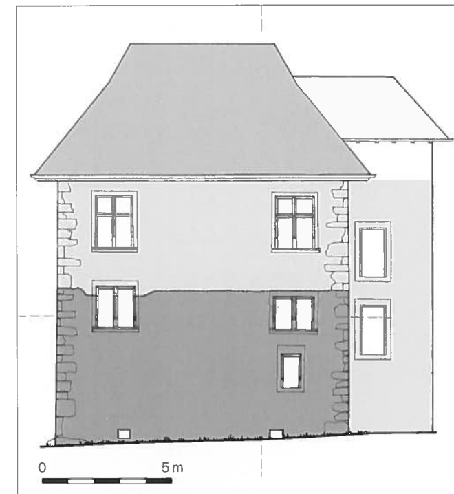
Abb. 12 Ostfassade. Dunkelgrau: die älteren Bauteile aus dem frühen 17. Jahrhundert; hellgrau: Bauteile aus der Zeit um 1650; mittelgrau: das Walddach von 1740; weiss: Treppenturmdach von circa 1830.
