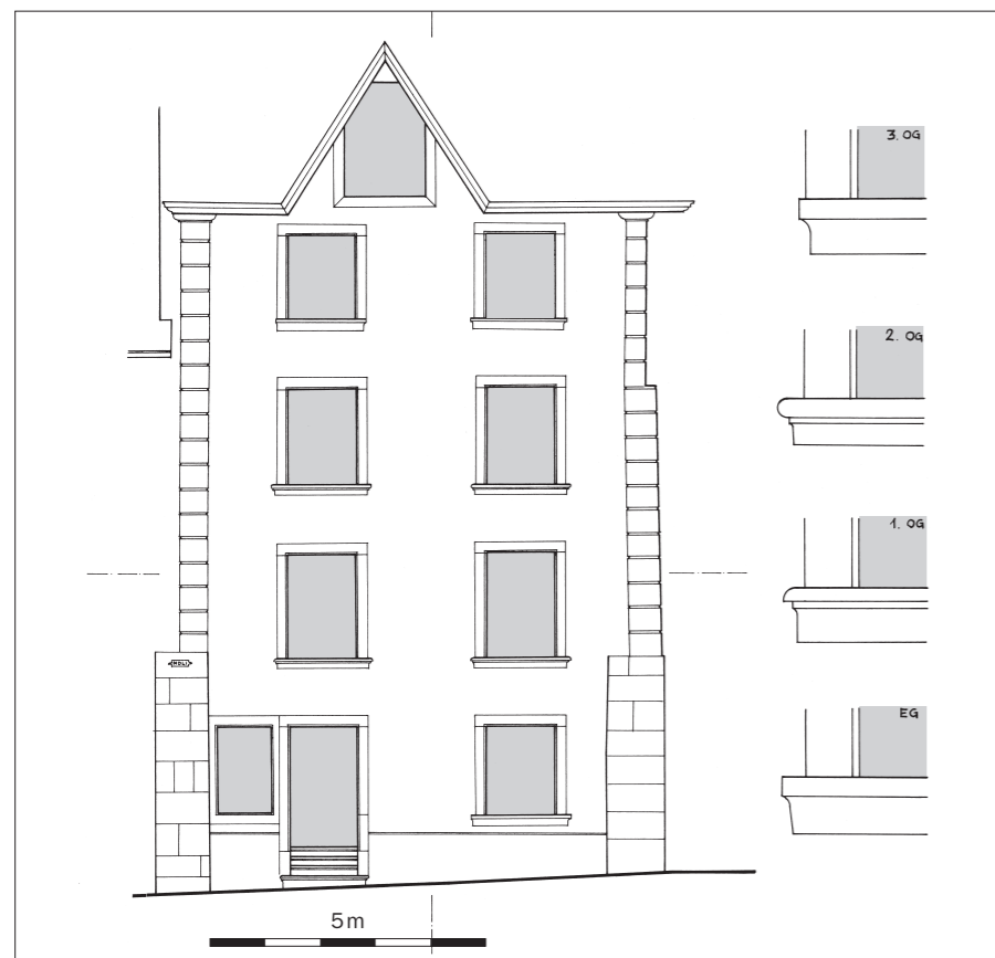
Abb. 2 Ostfassade an der Pfisterengasse, Planaufnahme mit Details der Simsprofile.
