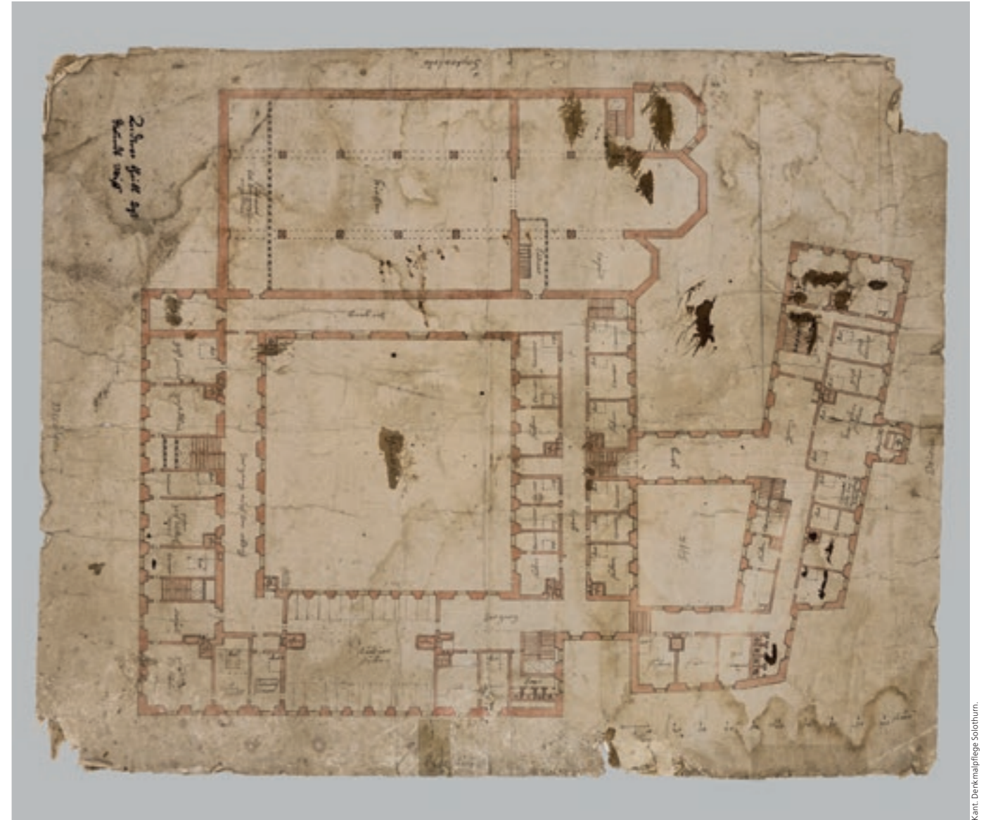
Abb. 34 Grundrissplan der Klosteranlage auf Höhe des ersten Obergeschosses, um 1695 (sogenannter Stockwerkplan). Der Plan zeigt einerseits detailliert die damals bestehenden Gebäude (Kirche, Konventstock) und andererseits eine in dieser Form nie realisierte Kreuzgangbebauung (Süd- und Westflügel). Klosterarchiv Mariastein.
