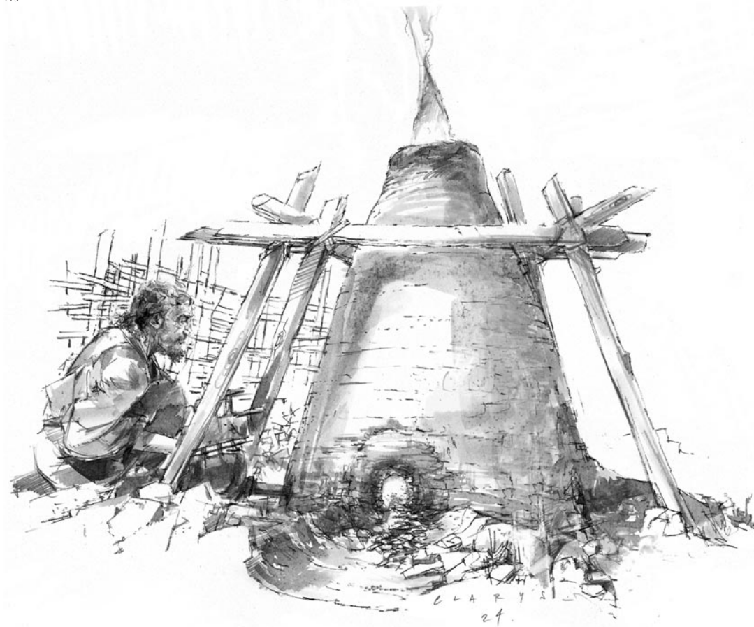
Abb. 115 Frühmittelalterliche Eisenerz- verhüttung im Rennofen. Die Rekonstruktion erfolgte in An- lehnung an Verhüttungsöfen, wie sie von anderen Fundstel- len aus dem mittelalterlichen Bergbaurevier im Jura bekannt sind.
