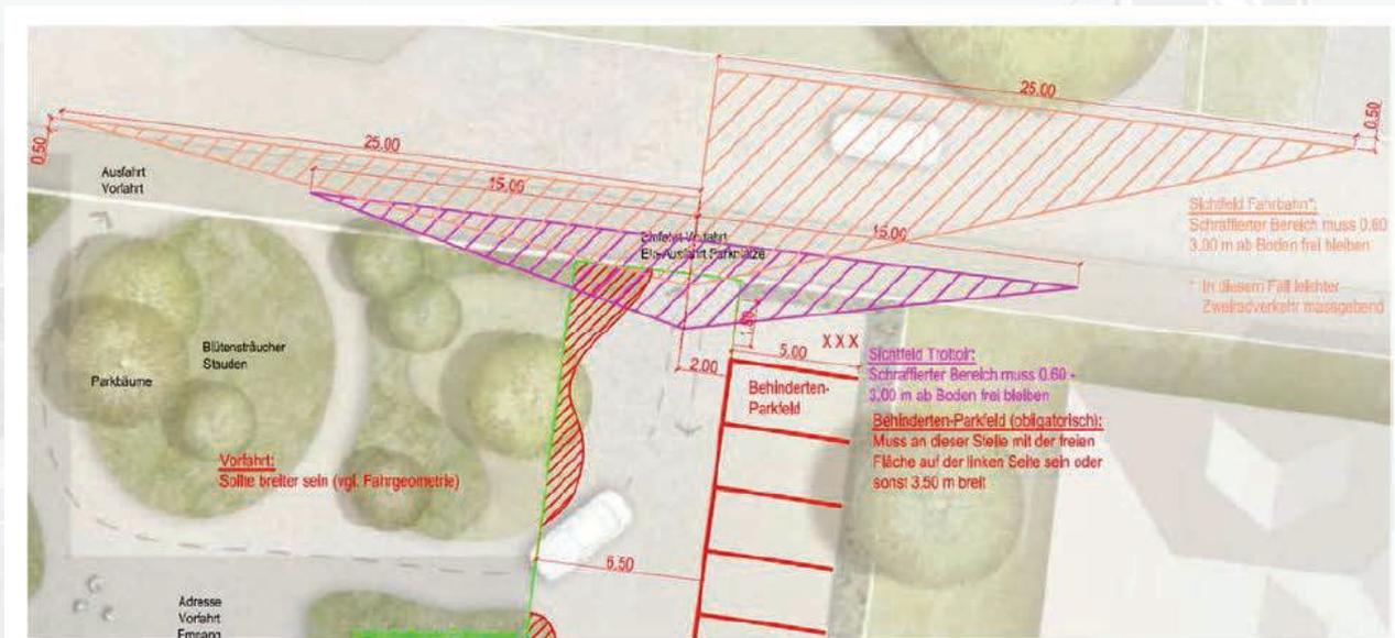
Abbildung 3: Sichtfelder Ausfahrt neue Parkierungsanlagen
