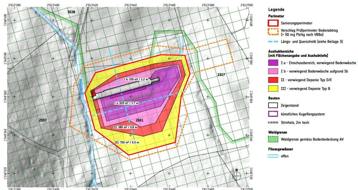
Abbildung 2: Sanierungsperimeter mit Aushubbereichen (Magma 2019, Beilage 1.5)
