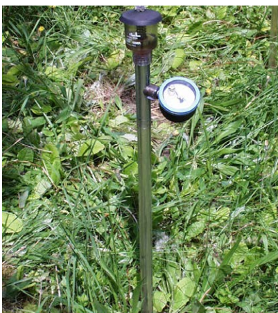
Tensiometer zur Messung der Bodenfeuchte
