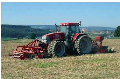
Traktor mit Doppelbereifung zur Bodenschonung
