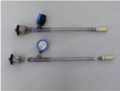
Mit dem **Tensiometer** wird die Saugspannung ermittelt. Durch die poröse Keramikkerze (weiss, rechts) und das wassergefüllte Rohr wird der hydraulische Kontakt des Bodenwassers zum Manometer (blau) hergestellt. Es wird gemessen, mit welcher Saugspannung das Wasser im Boden zurückgehalten wird. Dabei handelt es sich um einen Unterdruck. Die Masseinheit ist Centibar (cb).
