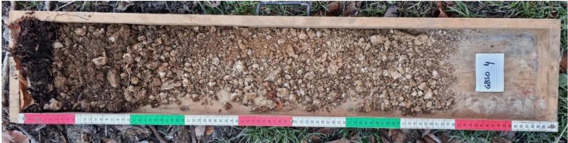
Abbildung 2. Bohrkern vom Probestandort Nummer 4
