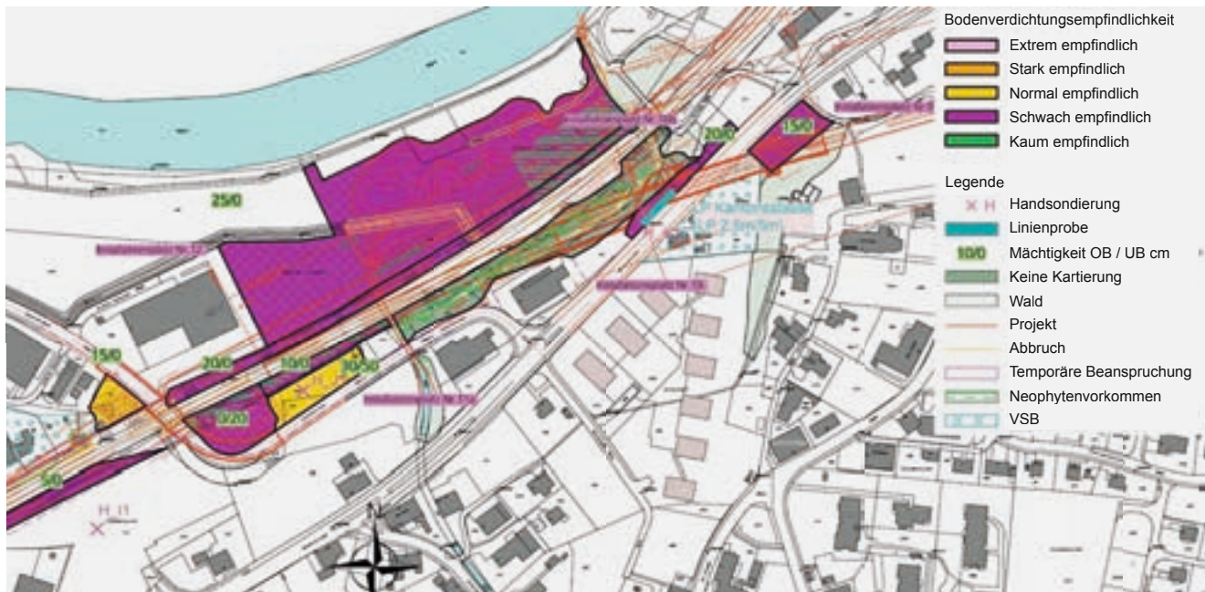
Abbildung 86: Ausschnitt aus der Bodenschutzkarte Eppenbergtunnel (SBB), mit den Angaben zu Verdichtungsempfindlichkeit und Bodenabtragsmächtigkeiten, im Raum Gretzenbach. CSD Ingenieure AG, 2014
