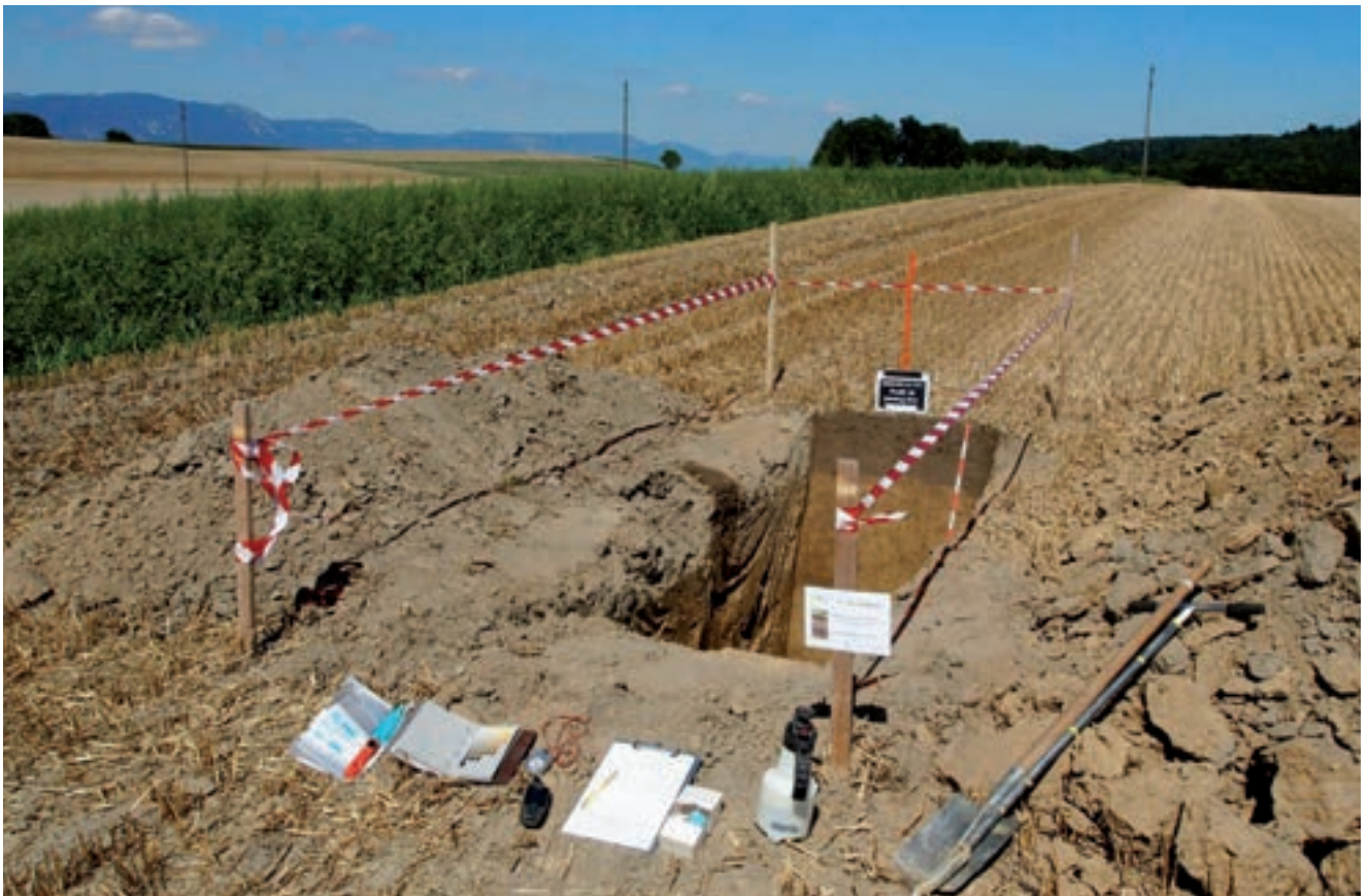
Abbildung 12: Profilgrube mit den wichtigsten Utensilien zur Bestimmung der Bodeneigenschaften an der Profilwand und in der Umgebung: Probenahmebeutel, Farbtabelle zur Bestimmung der Bodenfarbe, GPS-Gerät, Hangneigungsmesser, Profilblatt, pH-Meter und Wasser zur Befeuchtung der Profilwand.
