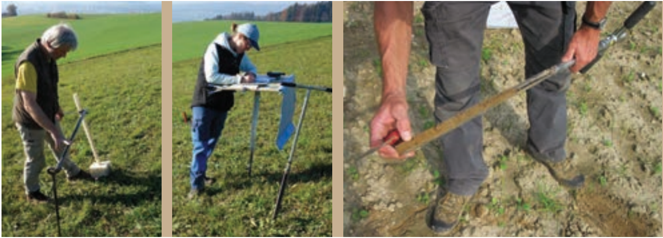
Abbildung 13: Kartierfachleute bei der Flächenkartierung mit Handbohrgeräten und Kartiertisch.
