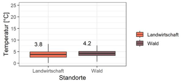
Abbildung 25: Jahreszeitabhängige Bodentemperatur in 20 cm Tiefe der Landwirtschafts- und Waldstandorte, über alle Standorte. Die Box gibt den Bereich an, in dem die mittleren 50 % aller Werte liegen. Die horizontale Linie innerhalb der Box repräsentiert den Median. Ausreisser werden nicht abgebildet.
