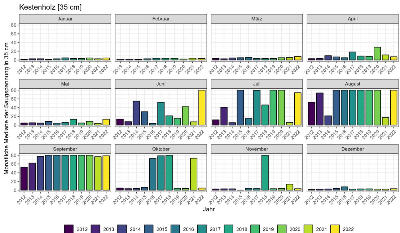
Abbildung 21: Monatliche Saugspannungswerte (Median) in Kesteholz 2012-2022
