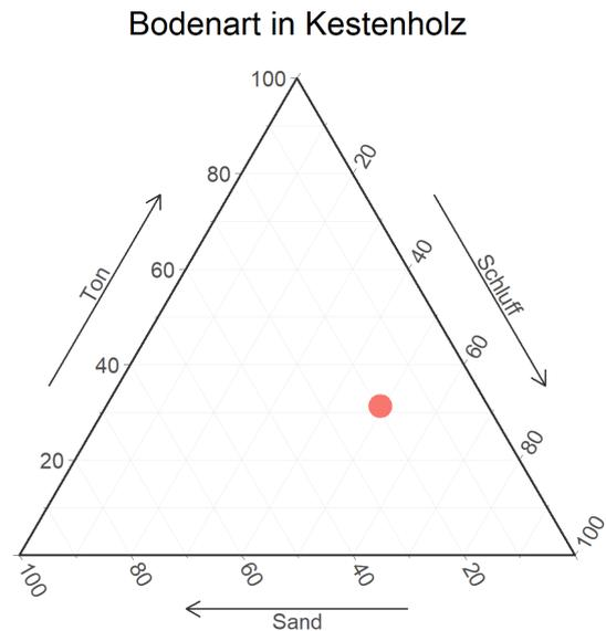
Der Standort Kestenholz liegt auf einem normal durchlässigen mittelschweren Fluvisol. So trocknete der Boden in Kestenholz im Frühling 2012 am schnellsten ab und erreichte bereits im März Messwerte >6 cbar. Im Juni stieg die Saugspannung erstmals über 20 cbar. Ab Anfang Juli bis Ende September gab es eine längere Trockenphase mit einem kurzen Unterbruch Anfang September. Ab Anfang Oktober war es dann mehrheitlich «nass».
