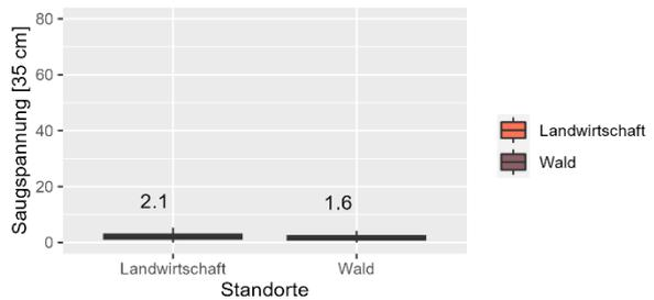
Abbildung 26: Vergleich der jahreszeitenabhängigen Saugspannungen in 35 cm Tiefe der Landwirtschafts- und Waldstandorte über alle Standorte anhand von Boxplots. Die Box an sich gibt den Bereich an, in dem die mittleren 50 % aller Werte (d. h. aller Tagessummen) liegen. Die horizontale Linie innerhalb der Box repräsentiert den Median. Ausreisser werden nicht abgebildet.
