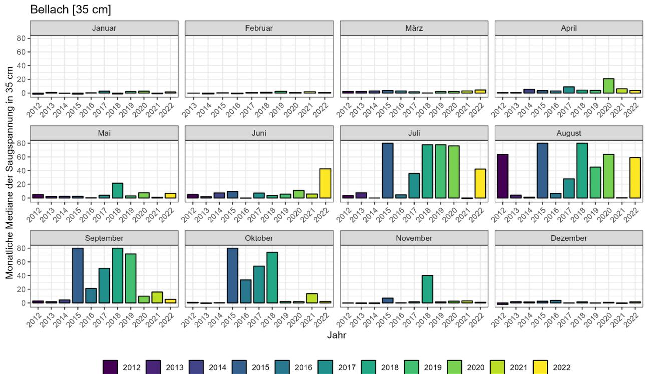
Abbildung 22: Monatliche Saugspannungswerte (Median) in Bellach 2012-2022
