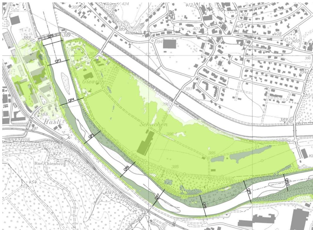
Abb. 6.4: Intensitätskarte HQ<sub>100</sub> ohne KW vor Massnahmen 2008
