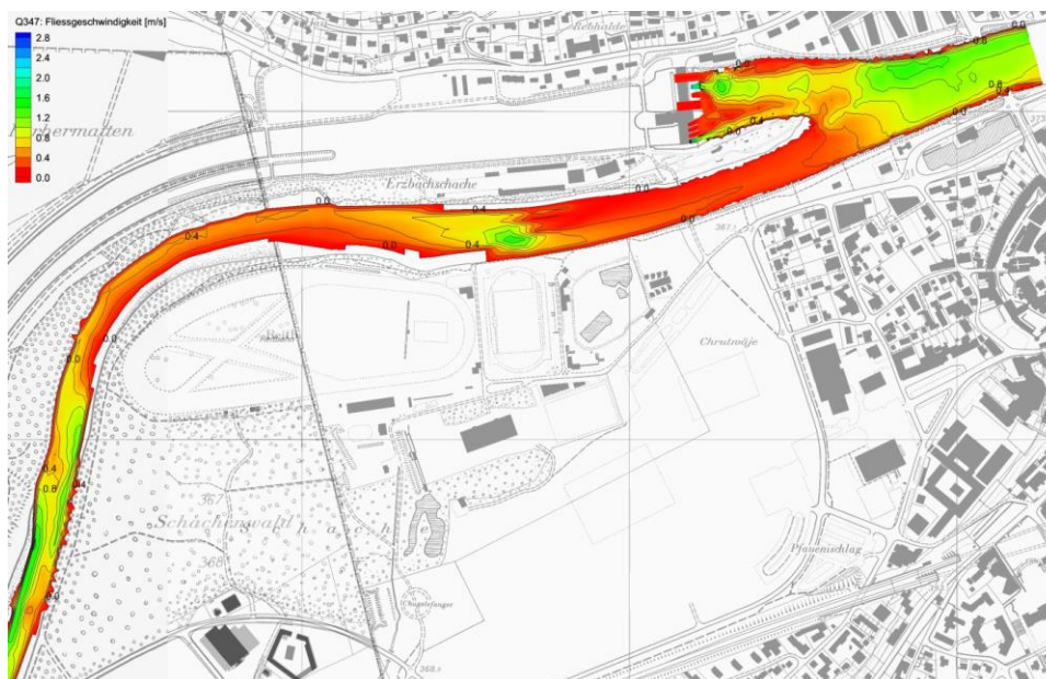
Abbildung 6.2.2: Tiefengemittelte Fließgeschwindigkeit Q 347 ( Q_{Aare} = 140 \text{ m}^3/\text{s} ) während Niederwasser.
