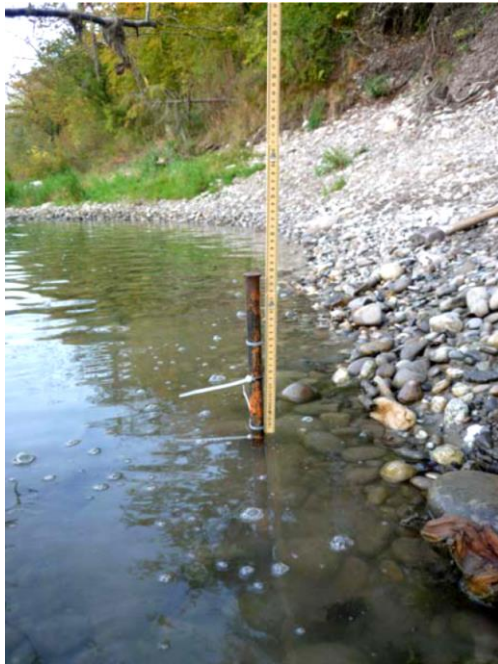
Abbildung 2.4.2: Messung Wasserspiegel bei der Kiesbank am rechten Ufer bei der Rennbahn bei 25 \text{ m}^3/\text{s} .
