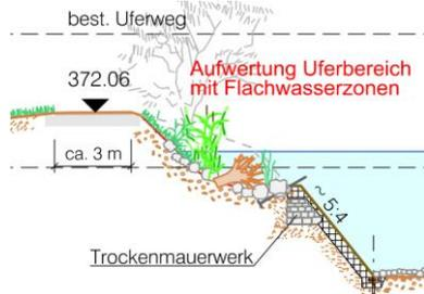
Abbildung 24: Querprofil Aufwertung Ufer bei Mündung Erzbach
