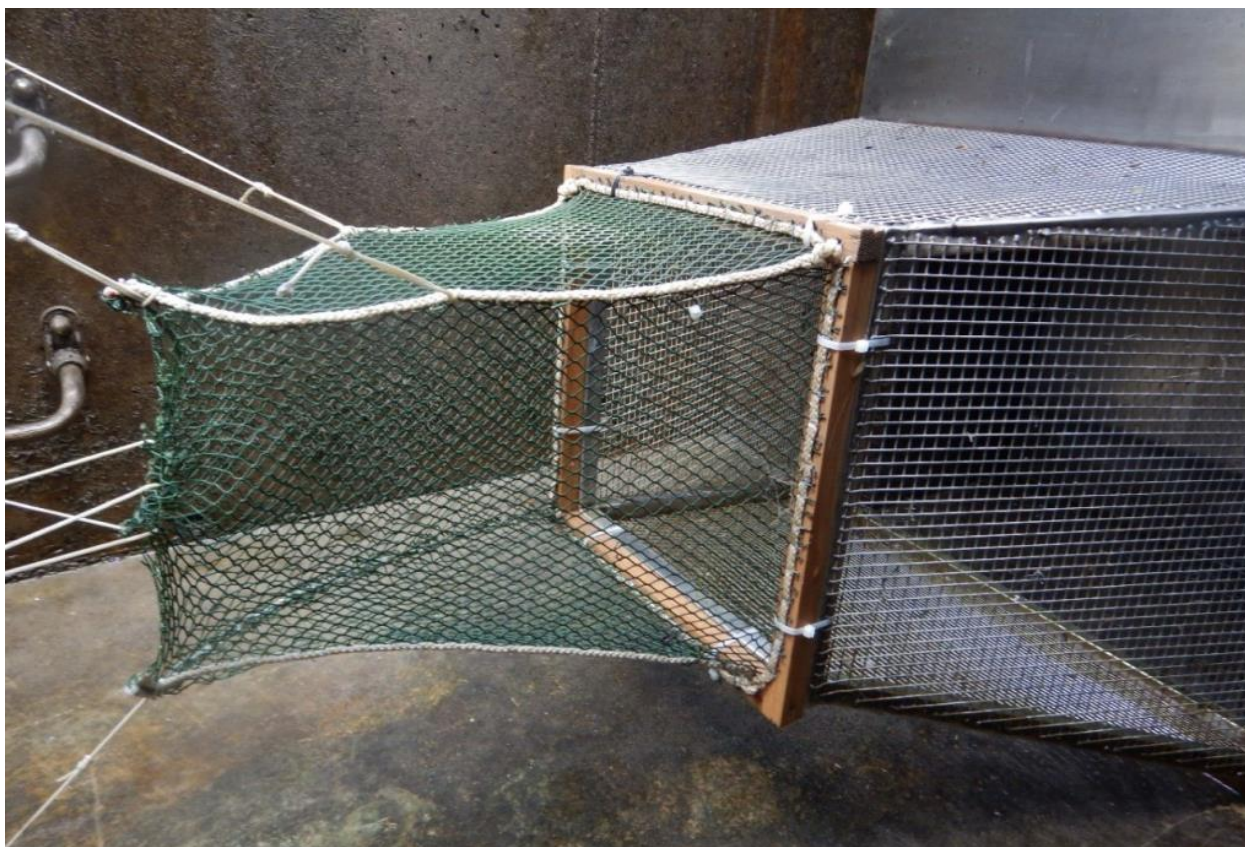
Abb. 5.5 Adaptierte Reusenkehle nach dem System von FishConsulting [10].
