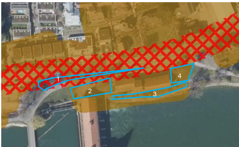
Abb. 35 Übersicht Prüfperimeter Bodenaushub (Braun und Rot) inkl. Lage und Nummerierung der Bodenbeprobungen (blaue Polyeder).
