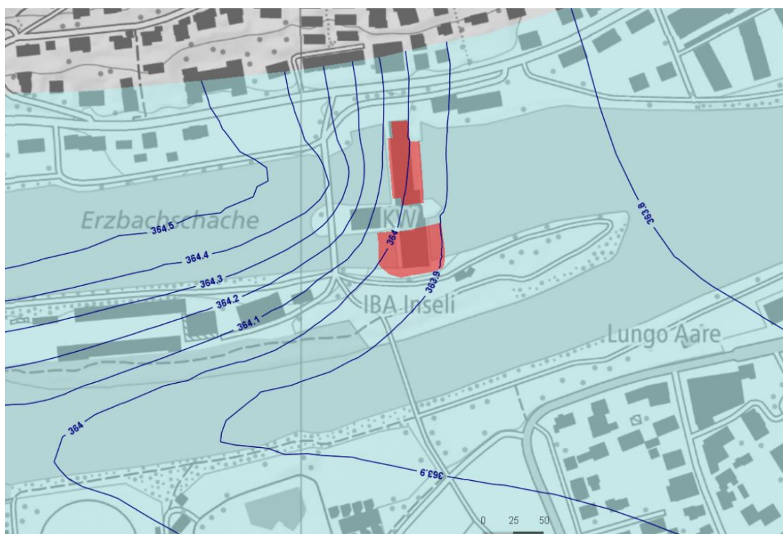
Abb. 14 Modellierter Grundwasserspiegel (Isohypsen) bei Mittelwasserstand beim Kraftwerk (Ausgangszustand)
