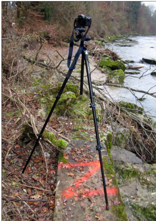
Abb. 1 Kamera auf Stativ am Ufer der Emme. Als Markierung wurde ein rotes Z auf der Ufermauer, einem Stein oder einem Baum, angebracht.
