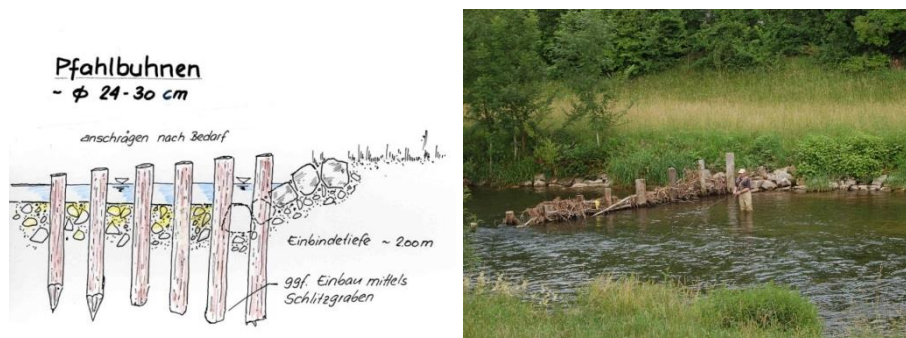
Abbildung 28 Prinzipskizze Pfahlbuhne (links; [49]); Pfahlbuhne in der Emme (rechts; [48])
