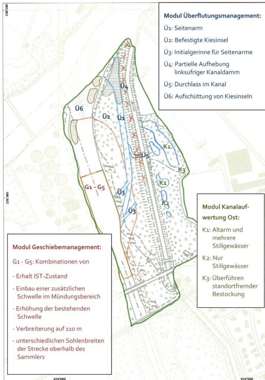
Abbildung 57 Darstellung der untersuchten Varianten
