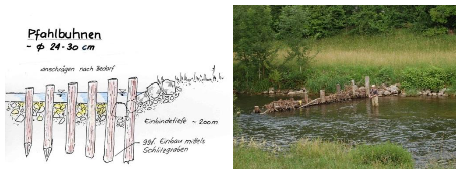
Abbildung 28 Prinzipskizze Pfahlbuhne (links; [47]); Pfahlbuhne in der Wiese (rechts; [46])
