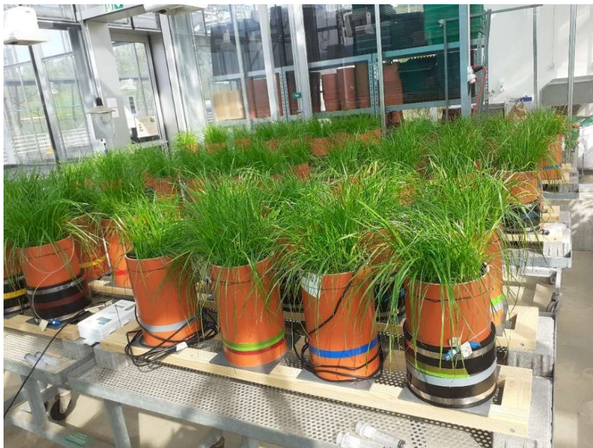
Abbildung 16: Säulenversuch zur Untersuchung von Massnahmen zur Verbesserung der Stickstoffnutzungseffizienz von Rindergülle
