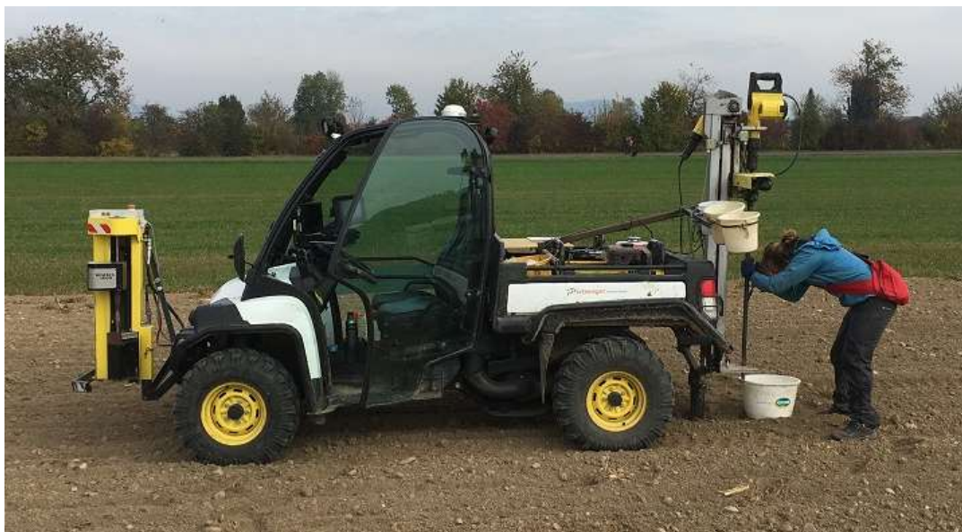
Abbildung 8: Bodenprobenahme mit dem automatischen Stechgerät von bodenproben.ch. Bild: Joe Santo
