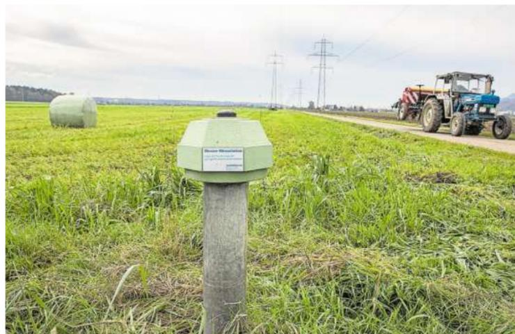
Eine Messstation zur Überprüfung der Grundwasserqualität.
