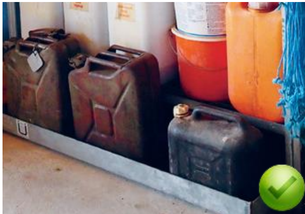
Quelle: AGRIDEA Auffangwanne vorhanden und ausreichend gross
