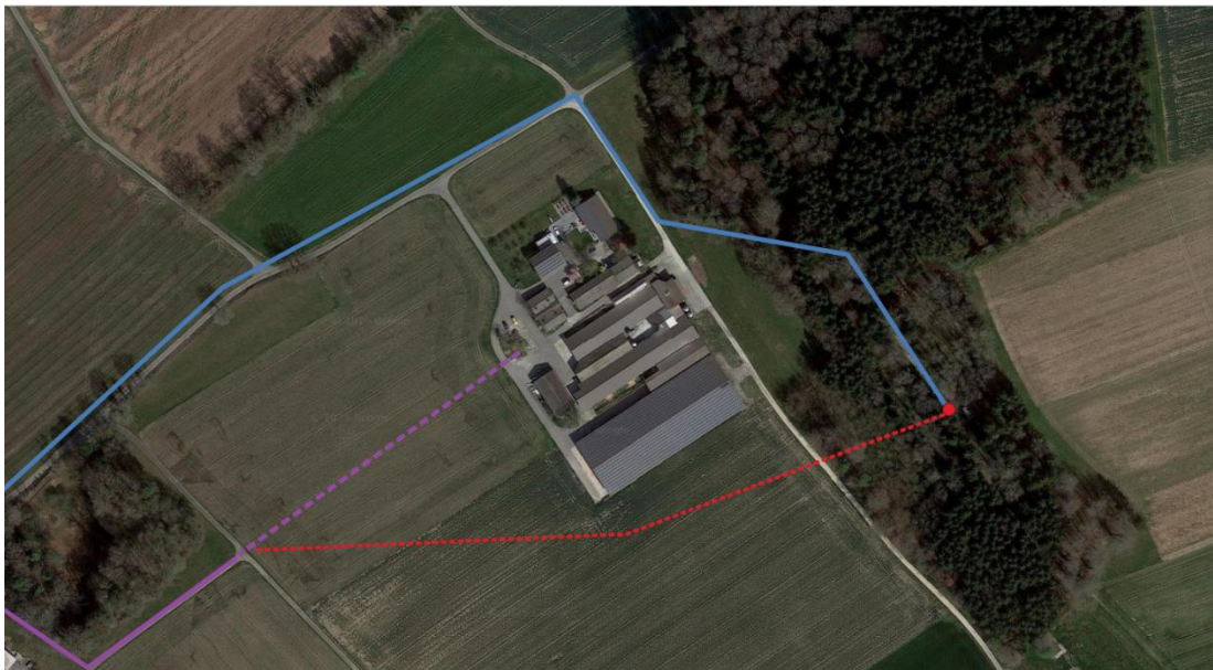
Abbildung 16: Übersicht Leitungsführung. Roter Punkt: Standort Aspiwäldli. Blaue Linie: Zuleitung Rohwasser vom PW Sagiacker zum Reservoir Aspiwäldli. Rote gestrichelte Linie: Neu zu erstellende Abwasserleitung zur Entsorgung des anfallenden CEB-Wassers. Violette Linie: Bestehende Abwasserleitungen (gestrichelt = Privatbesitz). Zur Einleitung des CEB-Abwassers in die Kanalisation muss eine etwa 400 Meter lange Einbindung an das Abwassernetz erstellt werden, siehe Abbildung 16. Da pro Tag lediglich ca. 4 m 3 Abwasser in die Kanalisation eingeleitet werden müssen, kann die Leitung entsprechend klein projektiert werden.
