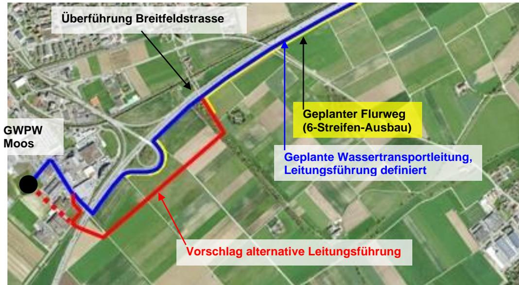
Abbildung 7: Alternative Leitungsführung "Mittelgäubach - Überführung Breitfeldstrasse" (Hintergrundkarte: geo.so.ch/map)
