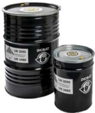
Gebrauchte und defekte Lithiumbatterien müssen in geprüften Stahlfässern (ADR-Code: 1A2) für die Verpackungsgruppe II gelagert werden. Das Stahlfass muss mit einem Inliner (Plastiksack, der das Leiten der Energie verhindert) ausgerüstet sein.
