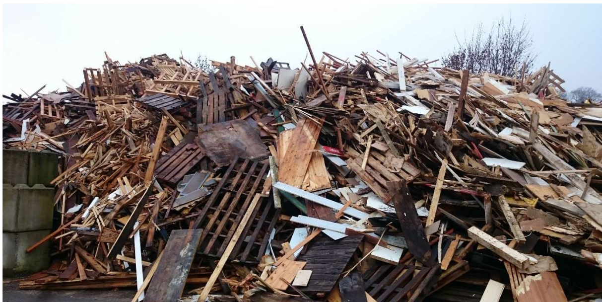
Altholz für die thermische Verwertung im Zementwerk
