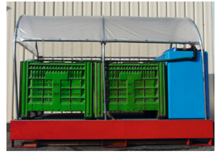
Biologische Behandlungssysteme ermöglichen den Abbau der PSM-Rückstände durch Mikroorganismen, CCD SA.
