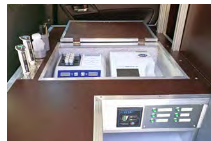
Das Labor für Abwasserproben im Servicewagen ermöglicht den Fachleuten gleich vor Ort eine Beurteilung der Reinigungsleistung von Kleinkläranlagen.
