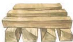
Das trockene, naturbelassene Brennholz als Kreuzbeige locker in den Feuerraum einschichten.
