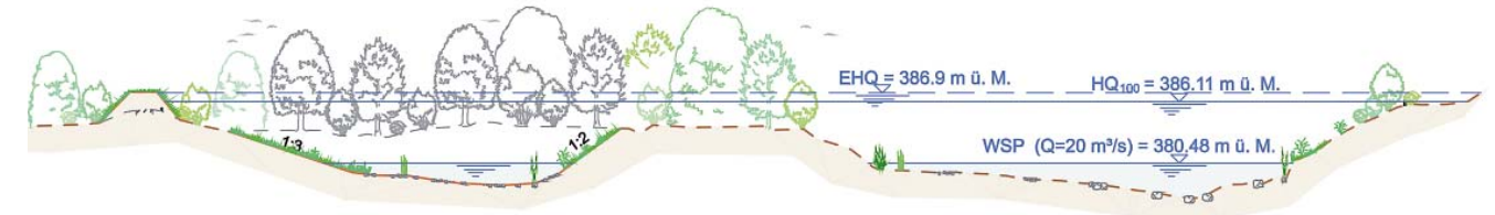
Typisches Querprofil (Dulliken – Winznau) mit Seitengerinne und Schutzdamm
