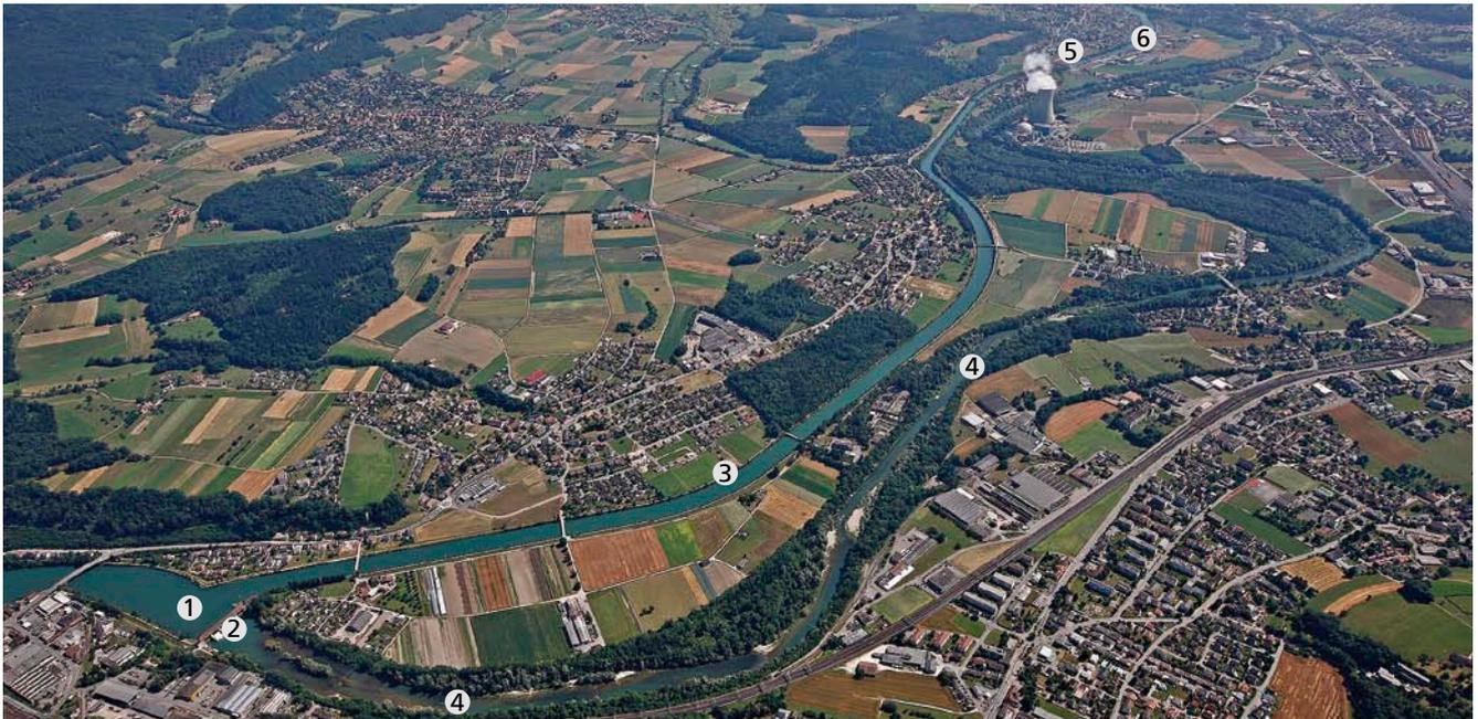
1. Staustrasse Wasserkraftwerk Gösgen (reicht bis Aarburg) · 2. Wehr Winznau · 3. Oberwasserkanal
