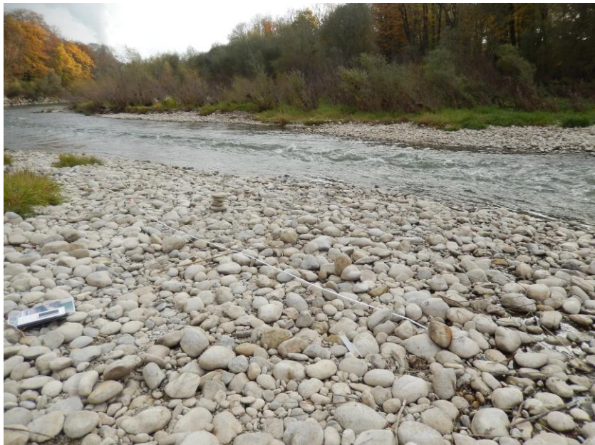
Abbildung 7: Größeres Geschiebe auf Kiesbank im unteren Bereich der Untersuchungsstrecke U2. Die Fließgeschwindigkeit im Gerinne ist erhöht, wodurch sich eine Deckschicht ausgebildet hat.
