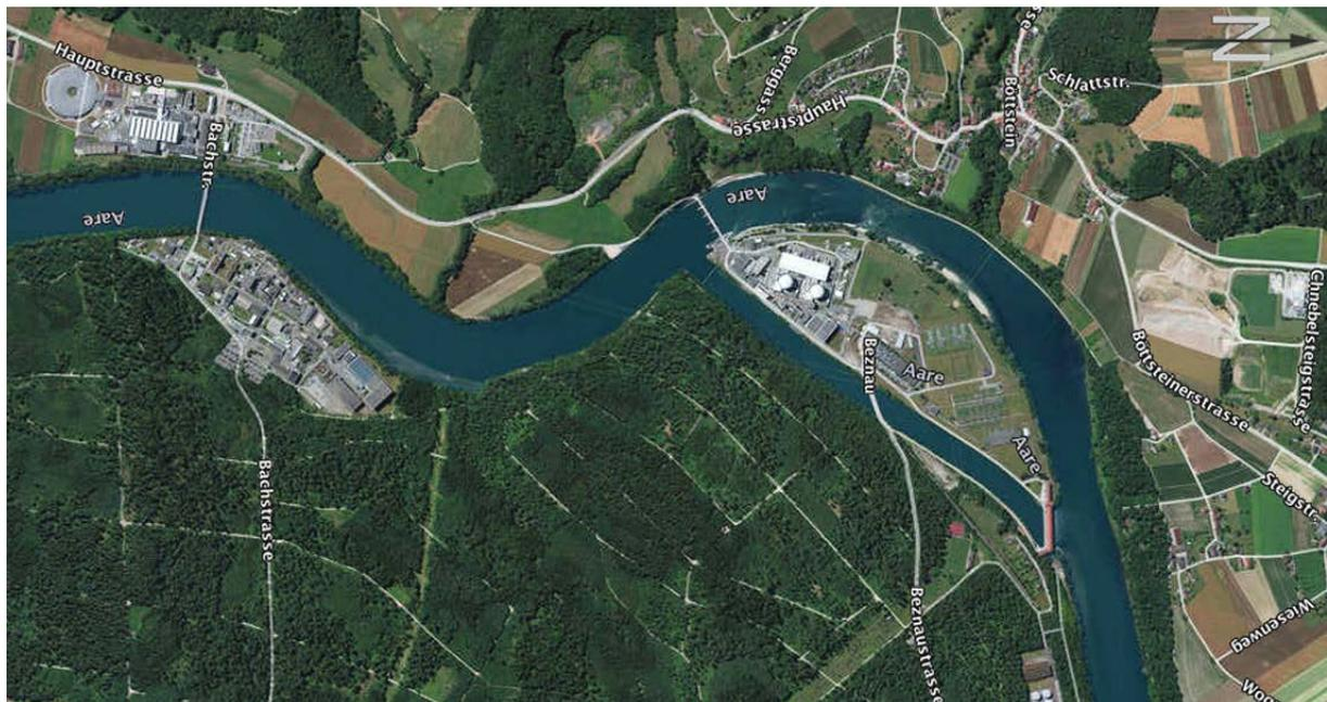
Bild 5.39 Stauwehr Beznau (obere Bildmitte) mit anschliessender Restwasserstrecke, Oberwasserkanal und Kraftwerk (unten rechts). Fliessrichtung von links nach rechts.
