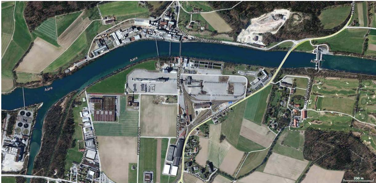
Bild 5.1 Aare zwischen der Emmemündung (links) und dem Kraftwerk Flumenthal (rechts). Kraftwerk mit Stauwehr (rechtsufrig) und Maschinenhaus (linksufrig).
