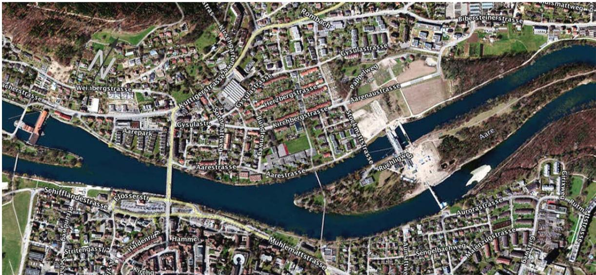
Bild 5.24 Stauwehr Ruchlig (rechts unten) in Restwasserstrecke sowie Kraftwerk im Kanal. Links aussen ist das Kraftwerk Aarau und rechts daneben die Kettenbrücke zu sehen. Fliessrichtung von links nach rechts.
