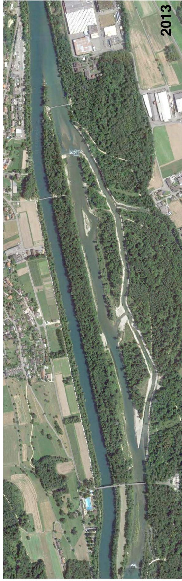
Bild 6.6 Aare bei Rapperswil – Auenstrecke mit der Restwasserstrecke (unteres Gerinne) und dem Unterwasserkanal des Kraftwerks (oberes Gerinne) 1961 (Landestopographie) und 2013 mit dem neu erstellten Seitengerinne.
