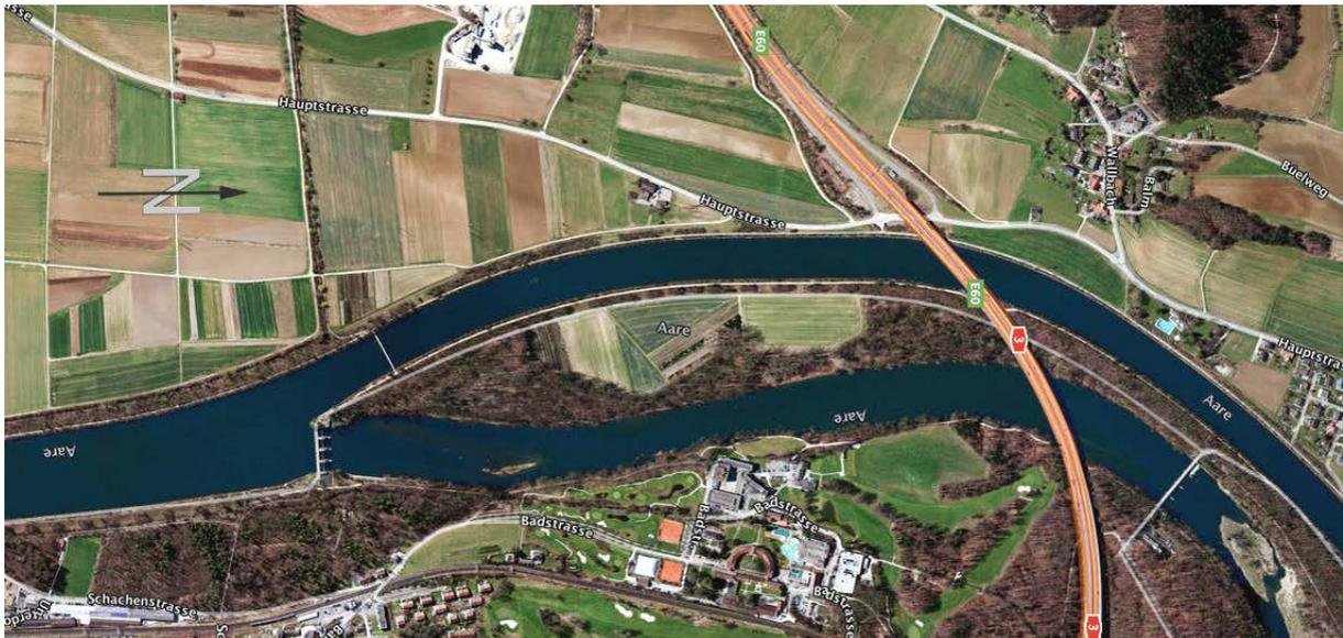
Bild 5.32 Stauwehr Wildegg-Brugg (unten links) mit Oberwasserkanal (oben) und Restwasserstrecke mit Hilfswehr (rechts unten).
