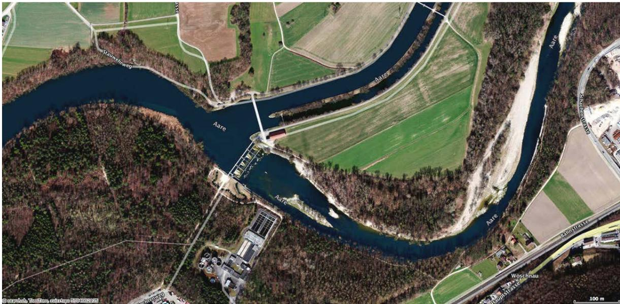
Bild 5.20 Stauwehr Kraftwerk Aarau mit Oberwasserkanal (links nach oben abzweigend) und der Restwasserstrecke mit Bänken.
