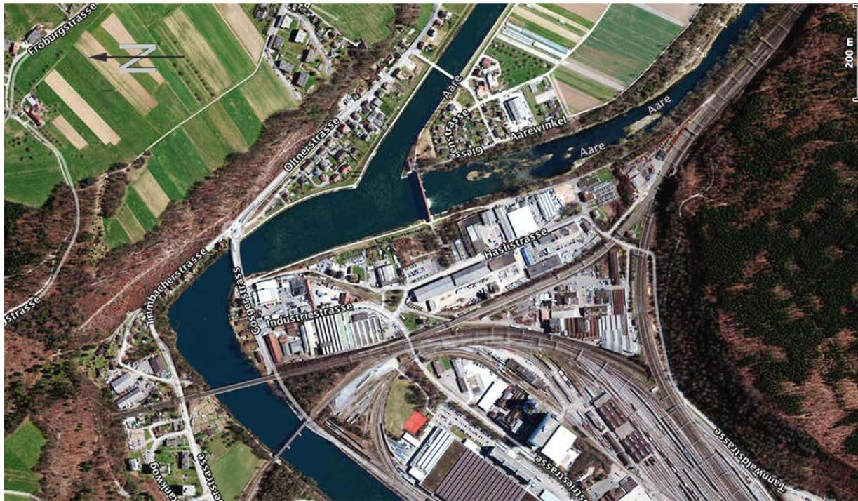
Bild 5.16 Stauwehr Winznau (in Bildmitte) mit Oberwasserkanal (links nach oben abzweigend) und der Restwasserstrecke mit Bänken.
