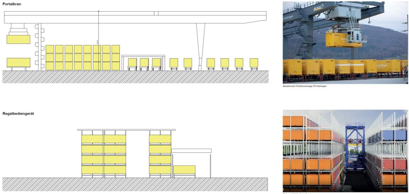
Abbildung 29: Oben System Portalkran, unten: System Regalbediengerät (Quelle: Richtprojekt PZH, ANS Architekten; eigene Ergänzungen)
