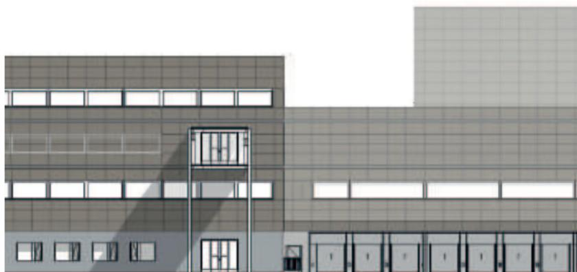
Betonsockel und Paneele angepasst an Geschoss- und Fensterbänderung
