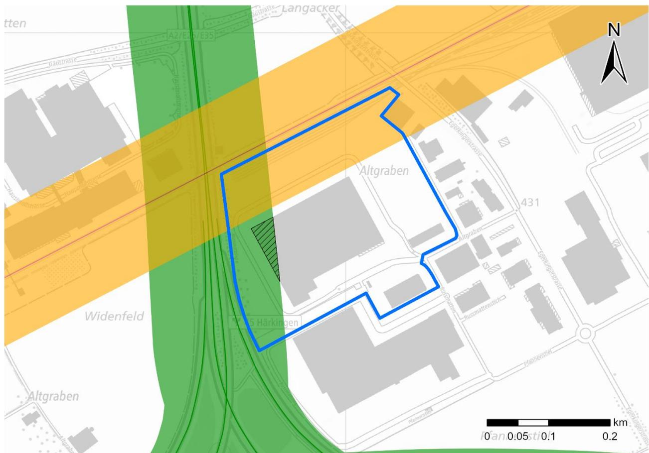
Abbildung 5-1: Störfallrelevante Anlagen, die nahe am Projektperimeter liegen, und deren Konsultationsbereiche. Orange: Eisenbahn, grün: Nationalstrasse, blau: Projektperimeter, schwarz schraffiert: betroffener Teil des Gebäudes. Quelle: geo.so.ch, Zugriff am 26.06.2024
