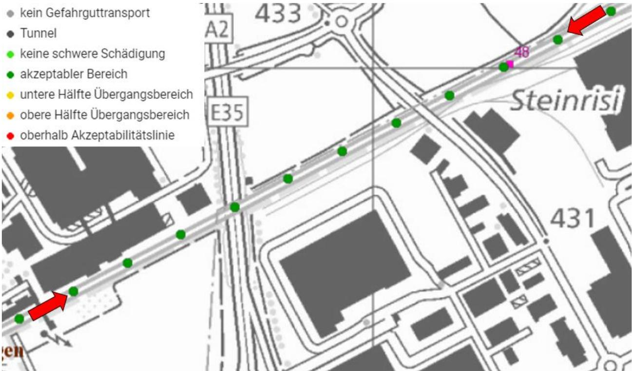
Abbildung 8-1: Personenrisiken alle Leitstoffe im Ist-Zustand (Printscreen aus der Applikation Screening TgG). Die 10 dargestellten Subelemente sind alle Teil der Risikobeurteilung (mit roten Pfeilen markiert).
