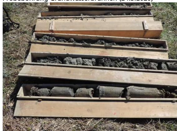
Bohrprofile für Hydrogeologie (24.3.2020)
