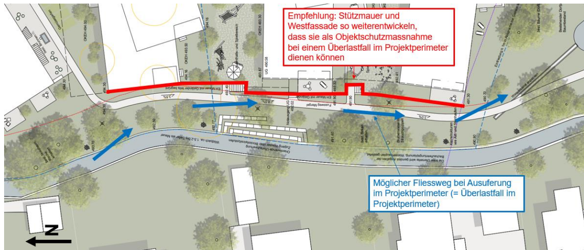
Abbildung 20: Empfehlung für Überlastfall: Westfassaden und Stützmauer als Objektschutzmassnahme weiterentwickeln
