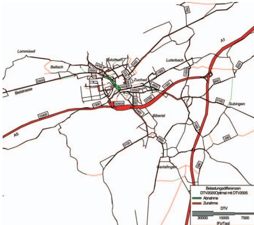
Abb. 6: Belastungsdifferenzen ‚Angestrebte Entwicklung‘ – heute (DTV 2020 optimal minus DTV 2005) (Quelle: Ingenieurbüro Roland Müller, Verkehrsmodell Solothurn/ Grenchen/Wasseramt, Juni 2007)
