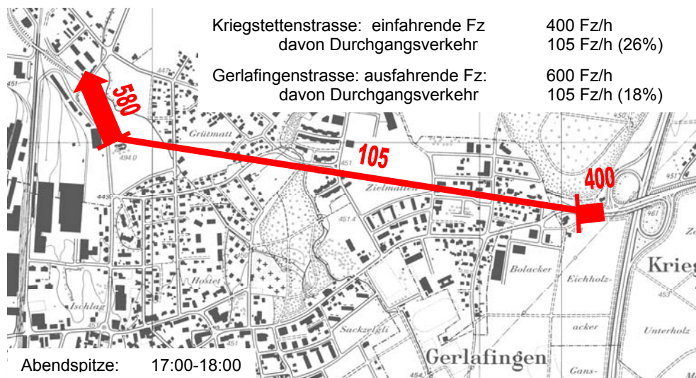
Abb. 32: Durchgangsverkehr Gerlafingen (Abendspitze) [Fz/h]
