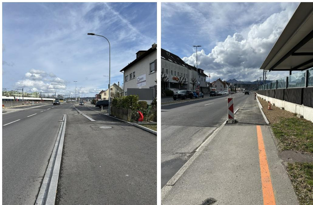
Abbildung 16: Neu realisierte Strassenraumaufteilung im Abschnitt 2 (Übergangsbereiche der Velofahrbahn)
